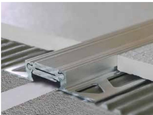
Il giunto GAS è stato ideato per essere installato sotto pavimento (piastrella, pietra o altro) e sopra il massetto. E' indicato per essere utilizzato in strutture commerciali, aeroporti e parcheggi, stazioni ferroviarie con passaggi pedonali e mezzi leggeri. Il giunto va installato in base alle specifiche tecniche derivanti dallo studio strutturale dell'edificio, in corrispondenza degli spazi esistenti tra due parti semi attaccate o tra due diverse campate.
